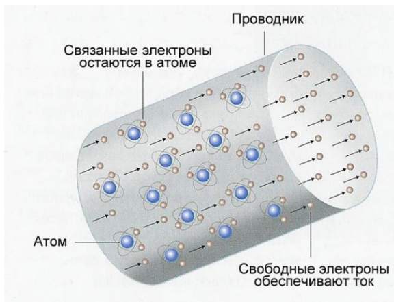
Рис. 8. Движение электронов, создающее ток.
